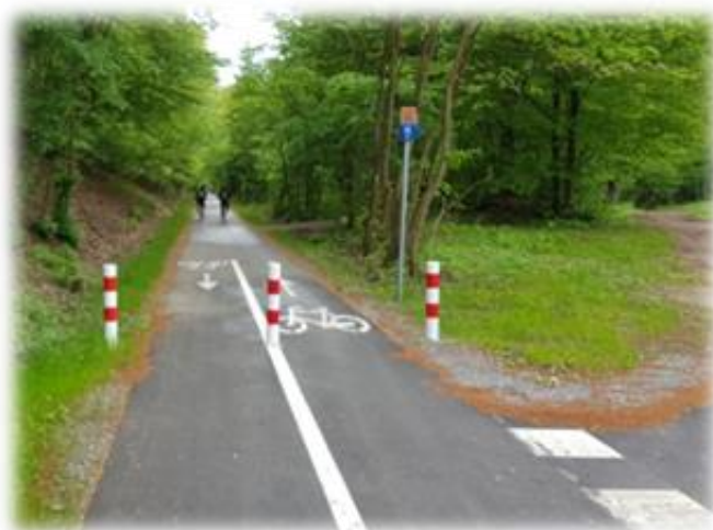
Foto. nr 1. Droga dla rowerów w obszarze leśnym, nawierzchnia asfaltowa, szerokość 2,50 m.
